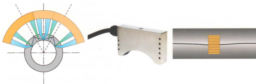
Рис. 5.87. Контроль ERW-труб фазированными решетками: принцип, вид преобразователя и пример отклонения линии сварного шва
