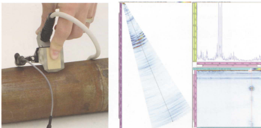
Рис. 5.40. Обнаружение фазированной решеткой усталостных трещин в трубе: преобразователь с датчиком координаты (слева), изображения дефектов (справа)
