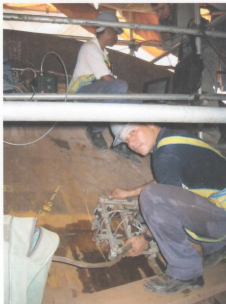
Рис. 5.63. Приспособление для ручного сканирования сварных швов. Данная версия может содержать фазированные решетки или несколько традиционных преобразователей (см. разделы 4.2.10 и 5.7.2)
