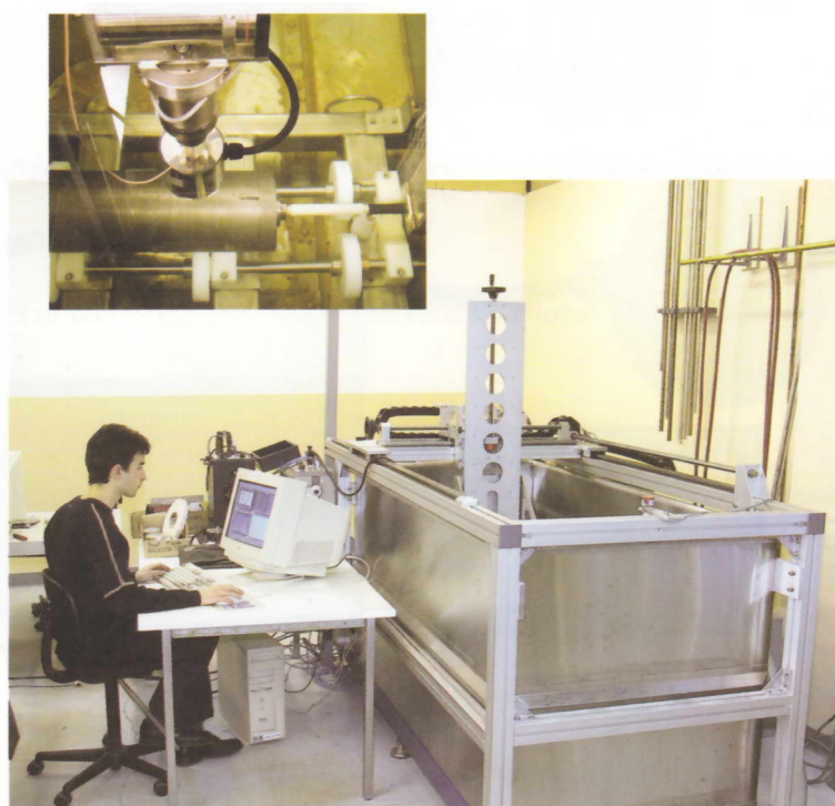
Рис. 5.14. Иммерсионный контроль титановых заготовок двумерной круглой фазированной решеткой.
