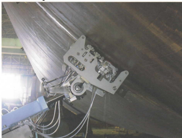
Рис. 5.60. Закрепленная акустическая головка, содержащая 2 фазированных решетки, контактирующая с вращающимся сосудом
