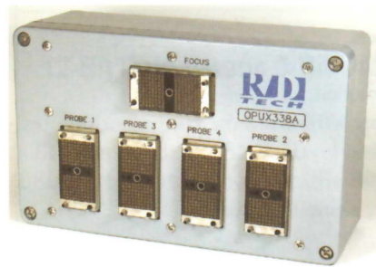
Рис. 3.59. Блок коммутаторов 4:1 со сканером на 4 преобразователя.
