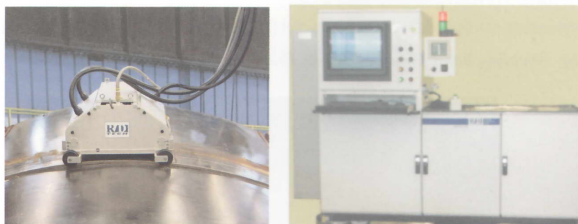
Рис. 5.59. Сканирующий блок системы PV-300 (слева) и система, смонтированная на тележке, включающая 3 блока TomoScan III или FOCUS, вихретоковую аппаратуру и систему обеспечения акустического контакта (справа)
