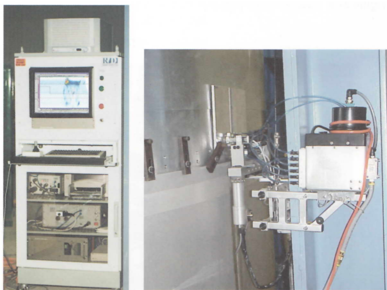
Рис. 5.17. Дефектоскоп, управляющий модуль и компьютер, установленные в кондиционированную стойку (слева); система рециркуляции воды (справа)
