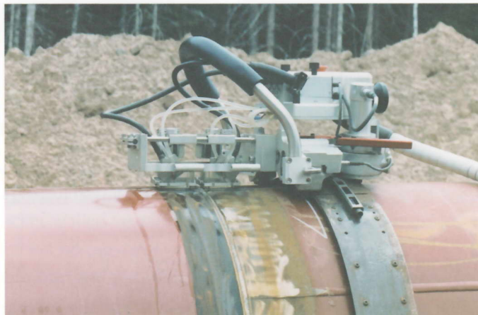
Рис. 5.61. Сканер, охватывающий трубу по периметру, содержащий 2 хорошо защищенных фазированных решетки
